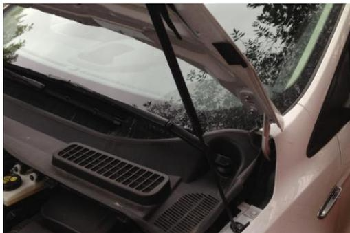
Прокачать амортизаторы (упереть в твердую поверхность несколько раз сжать и отпустить). Устанавливать амортизаторы штоком к крылу (см. фото).
