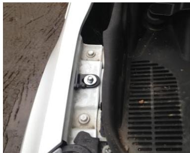
В технологические отверстия крыла установить крепление, как показано на фото.
