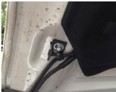
В технологические отверстия капота установить крепления, как показано на фото.
