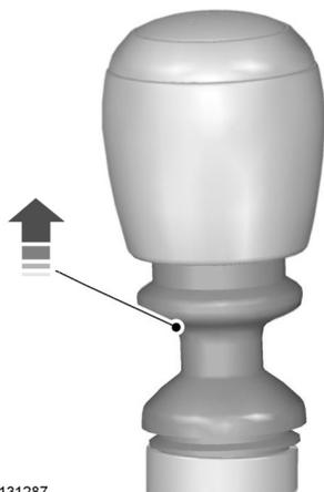
Для включения передачи заднего хода на автомобилях с 6-ступенчатой коробкой передач необходимо предварительно отвести вверх стопорное кольцо.
