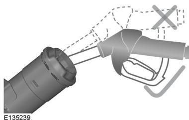
Вставьте наконечник топливопровода до нанесенной на нем первой отметки и удерживайте его в этом положении на топливозаправочной горловине.
