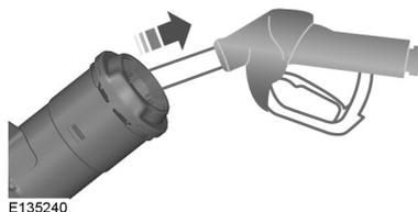
Для того чтобы извлечь заправочный пистолет, немного приподнимите его.
