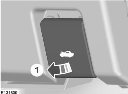
1. Потяните за рычаг, расположенный под панелью управления. Расположение элементов: См. **Быстрый обзор** (стр. 9).
