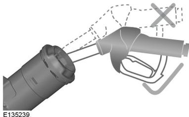
Вставьте заправочный пистолет до упора. Опустите заправочный пистолет, чтобы зафиксировать его у горловины топливопровода. Зафиксируйте его в указанной позиции и начните впрыск топлива посредством нажатия курка.
